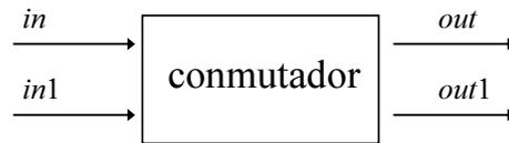
**Figura 3.7:** Modelo DEVS de un conmutador.
