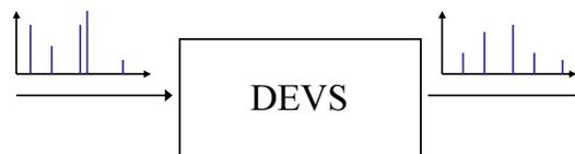
**Figura 3.1:** Comportamiento E/S de un modelo DEVS SISO.
