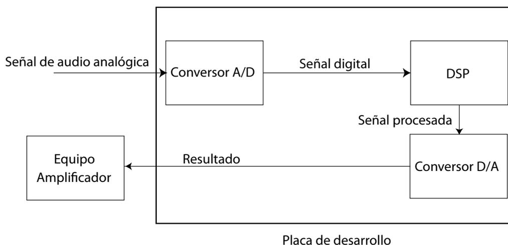
Figura 1.4: Esquema del camino de la señal usando la placa de desarrollo.
