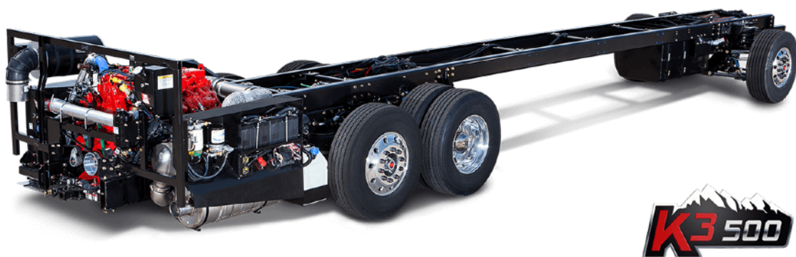
Figura 2.10. Chasis de un camión donde se representan las dos vigas en C apoyadas sobre un eje simple y un tándem doble (Imagen libre de copyright de la web (pngwing)).
