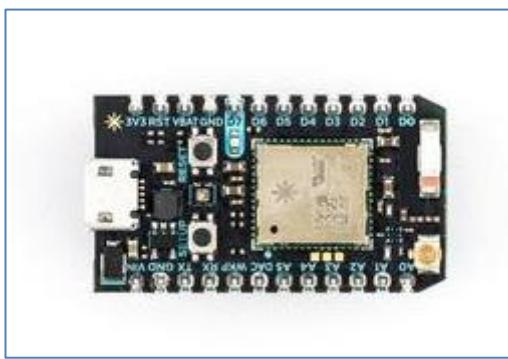
Figura 15 - Microcontrolador PHOTON. [particle.io]
