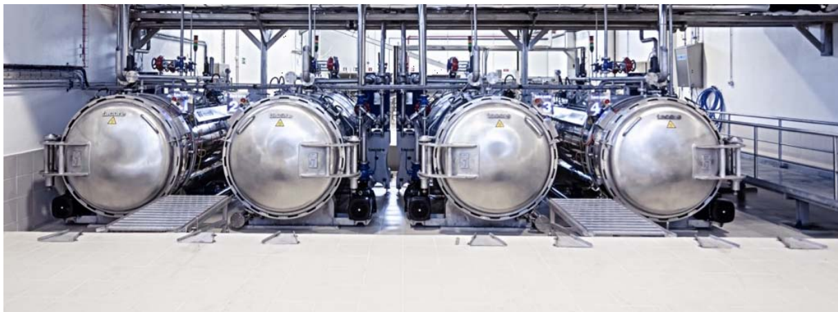
Figura 2.6. Autoclaves esterilizadores horizontales estáticos (tacore, 2024).
