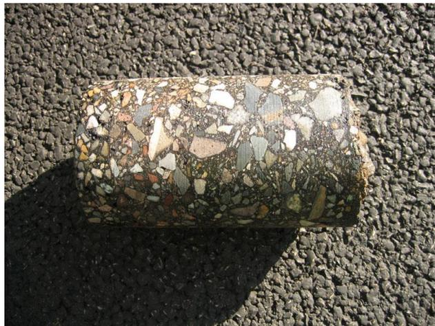
Figura 3.7 Testigo de mezcla bituminosa
