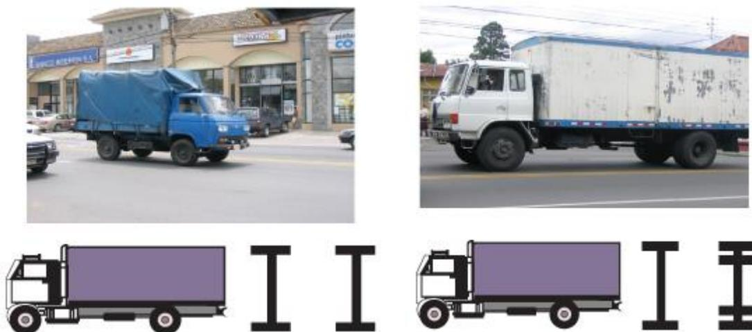
Figura 2.5 Distinta tipología de camiones en función de sus ejes
