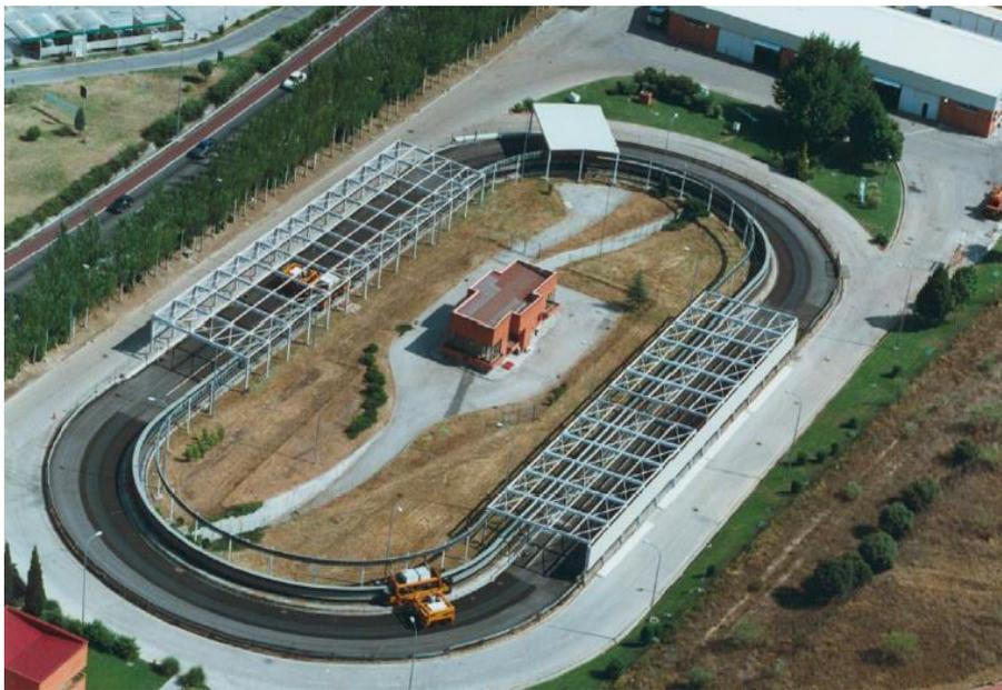
**Figura 1.3 Pista de Ensayo Acelerado de Firmes del CEDEX**
