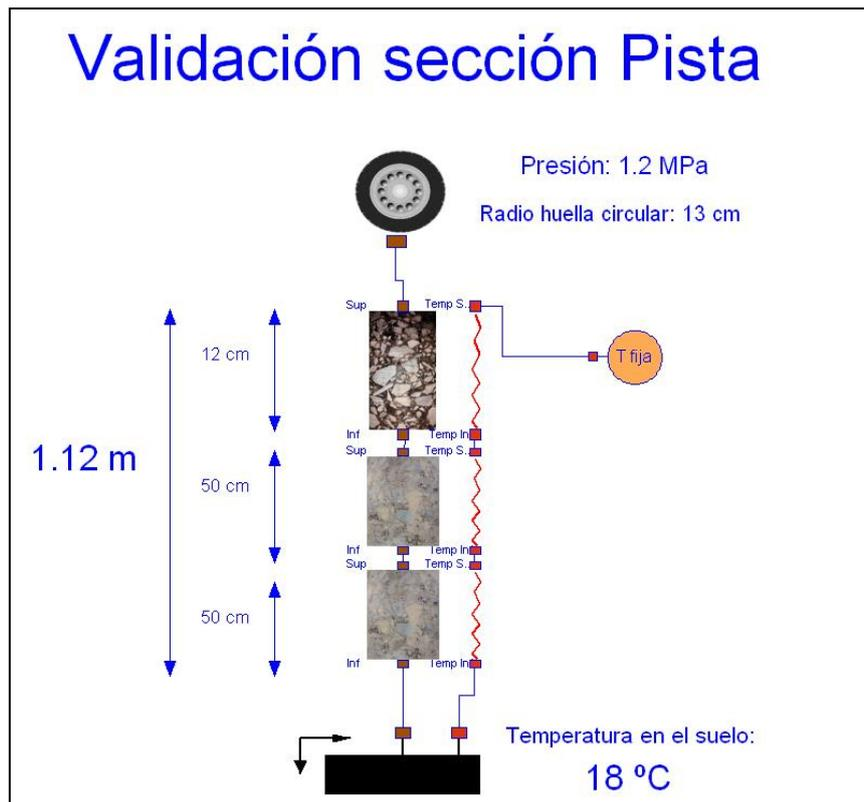
Figura 6.1 Modelo de simulación de una estructura de firme
