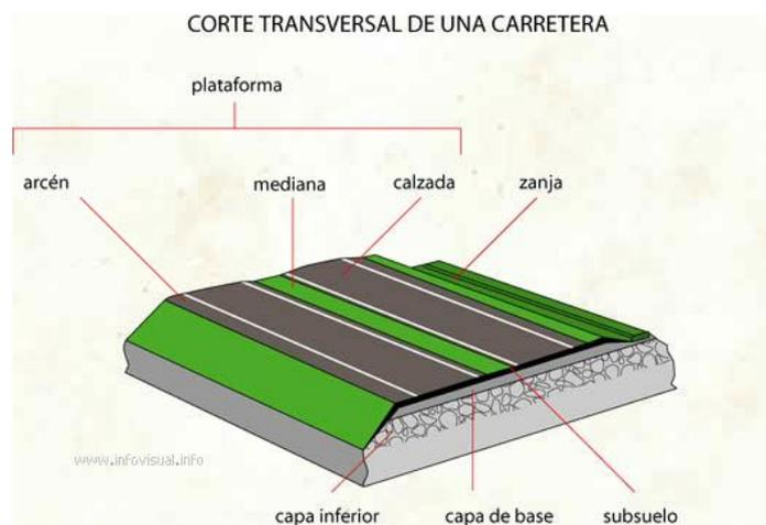
Figura 1.1 Capas que conforman la estructura de una carretera
