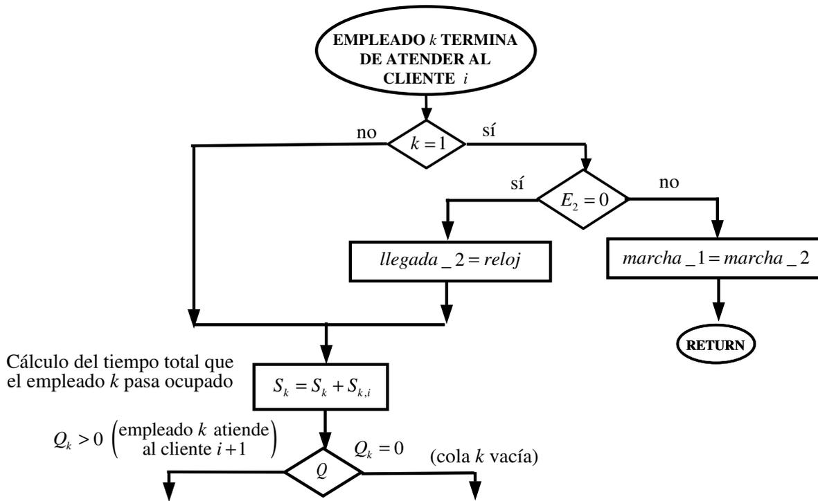
Figura 5.11: Modelado del bloqueo (Problema 5.10).
