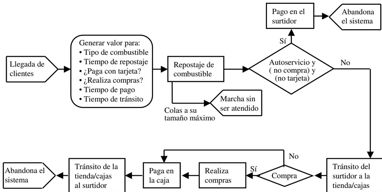
Figura 4.11: Modelo orientado al proceso: flujo de las entidades a través del sistema.
