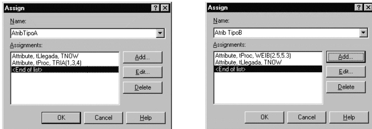
Figura 6.9: Definición de los dos módulos “Assign”.
