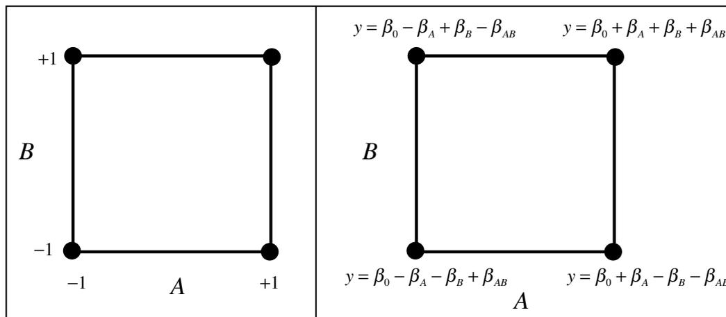
Figura 13.2: Diseño experimental. Niveles (izqda) y respuestas (drcha).
