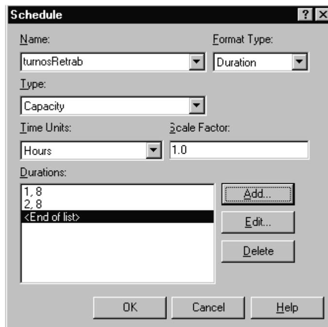
Figura 6.19: Planificación de la capacidad mediante la ventana de diálogo.
