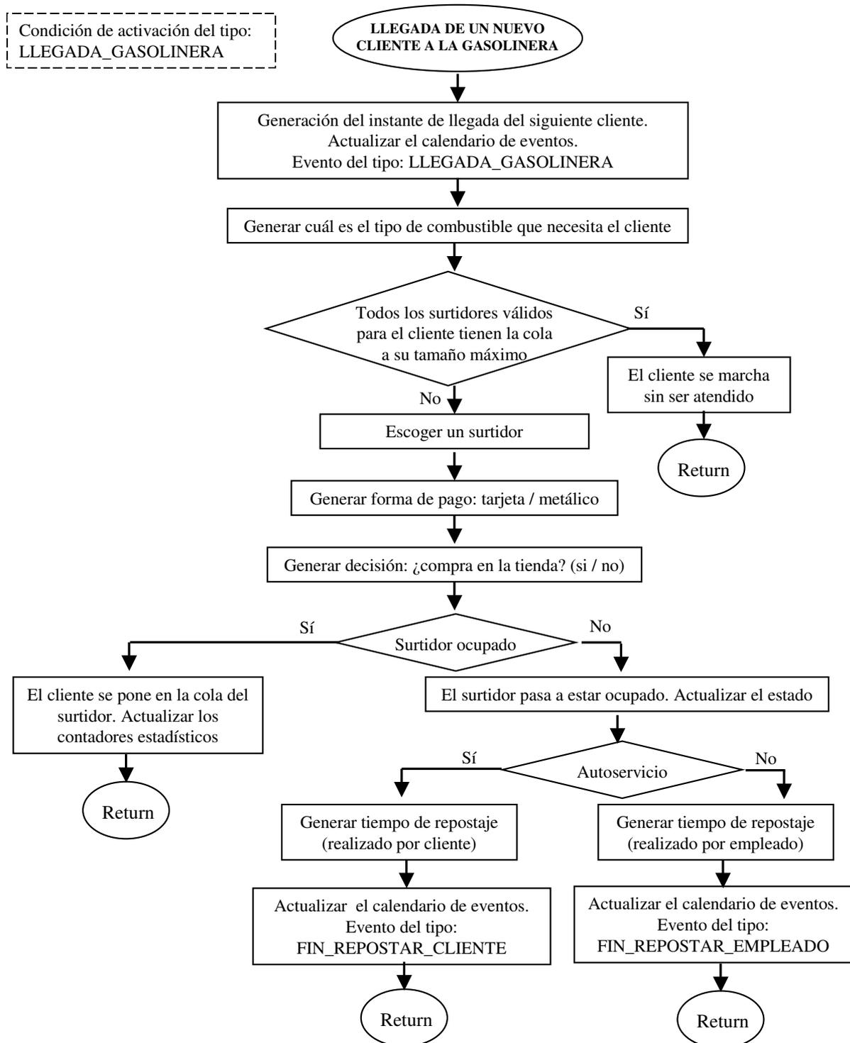
Figura 4.2: Flujo de acciones del evento “Llegada de un cliente a la gasolinera” (LLEGADA\_GASOLINERA).
