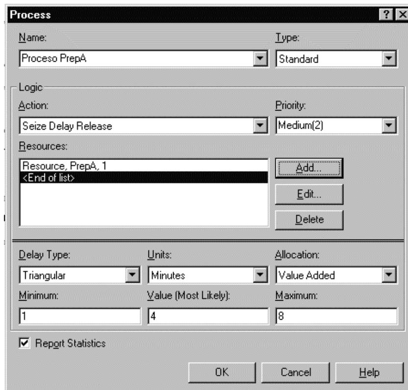
Figura 6.10: Definición del proceso de la Zona de Preparación A.
