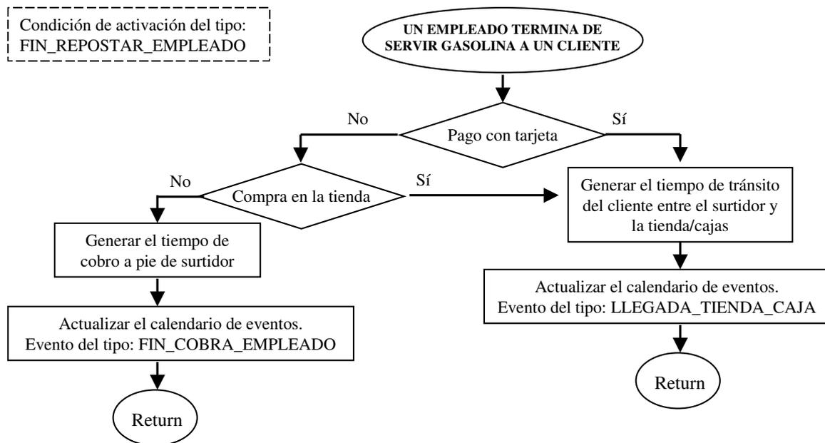
Figura 4.3: Flujo de acciones del evento “Un empleado termina de servir gasolina a un cliente” (FIN\_REPOSTAR\_EMPLEADO).
