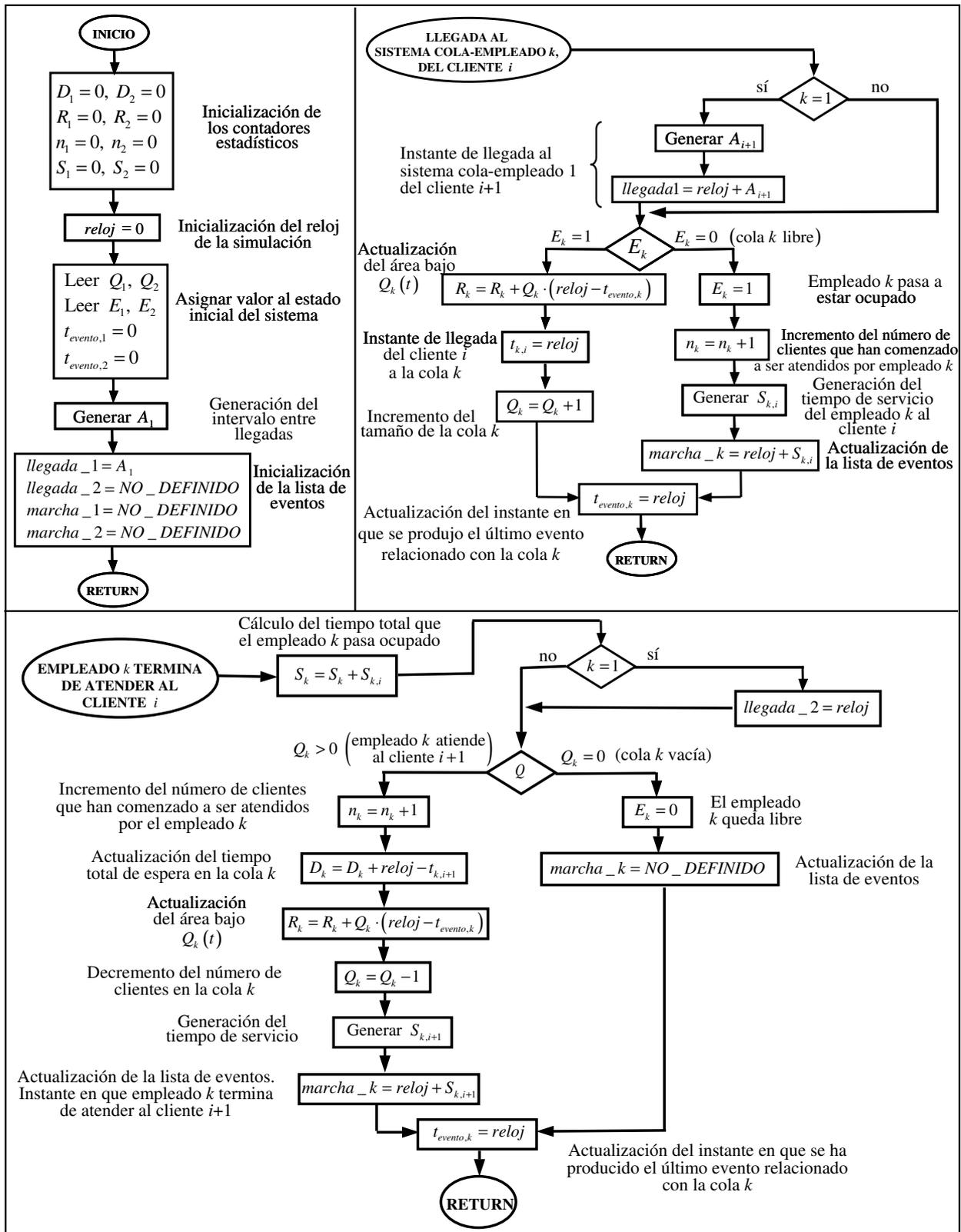
Figura 5.9: Flujo de acciones para dos sistemas cola-empleado en serie (Problema 5.8).
