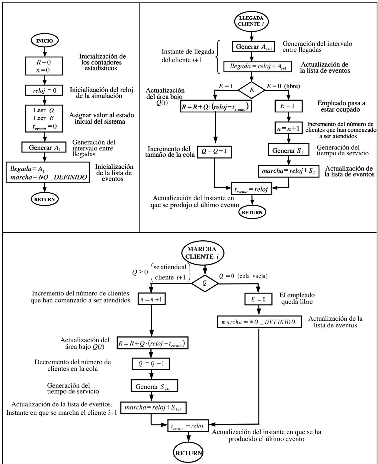
Figura 5.2: Flujo modificado para no calcular el tiempo medio en cola.
