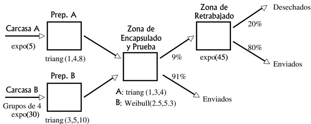
Figura 6.6: Sistema de ensamblado y prueba de circuitos electrónicos.
