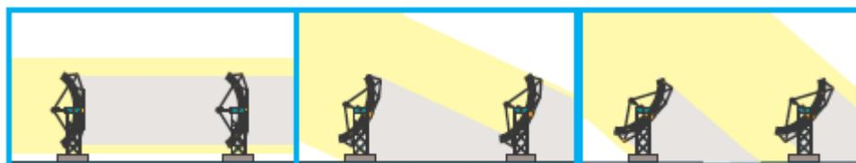
Figura 6.5: Ilustración del efecto de sombra entre filas
